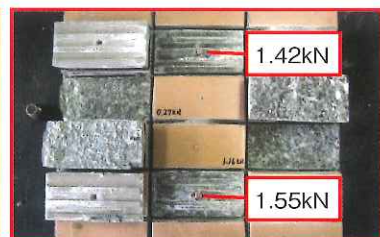
引張接着強さ試験 ※破壊はいずれもピンの頭抜け
